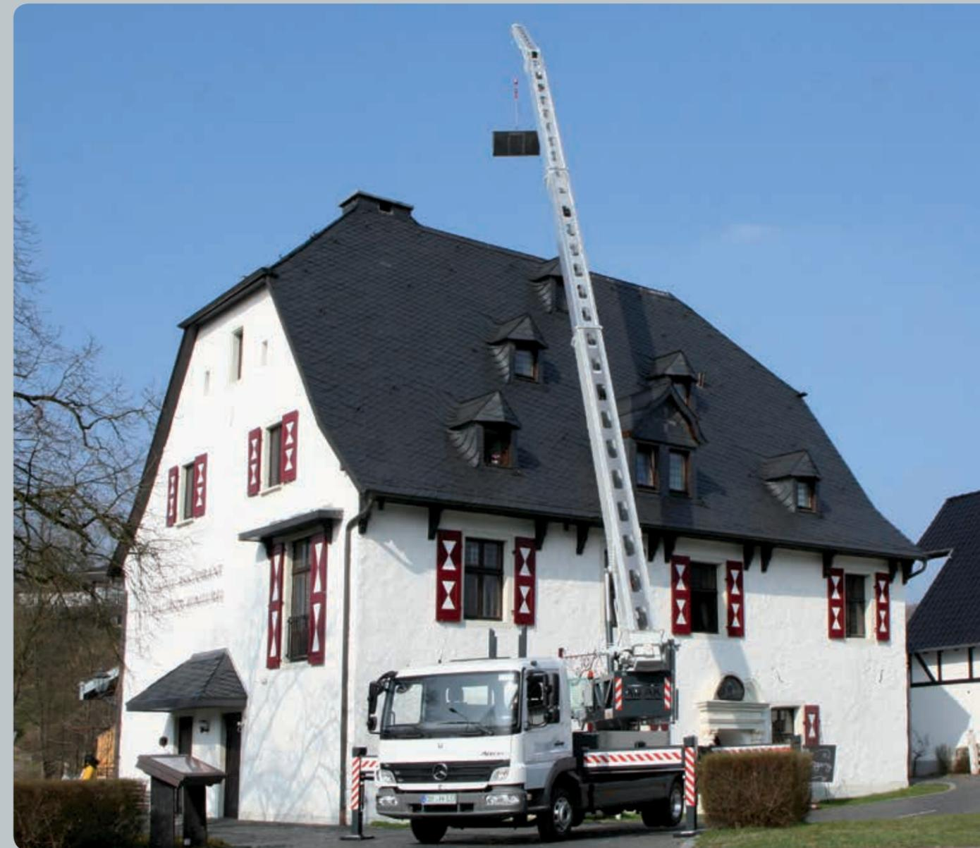
28 m seitliche Reichweite (250 kg) · 34 m Höhe · 3,0 t maximale Tragkraft
